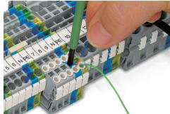
Raccordement du conducteur – Réducteur isolant de sécurité
