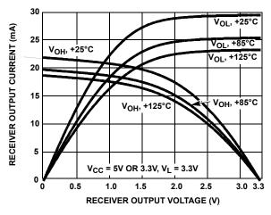
FIGURE 10. RECEIVER OUTPUT CURRENT vs RECEIVER OUTPUT
