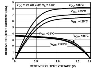
FIGURE 12. RECEIVER OUTPUT CURRENT VS RECEIVER OUTPUT VOLTAGE
