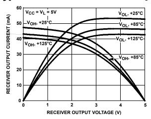
FIGURE 9. RECEIVER OUTPUT CURRENT vs RECEIVER OUTPUT VOLTAGE
