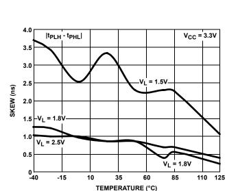
FIGURE 17. RECEIVER SKEW vs TEMPERATURE
