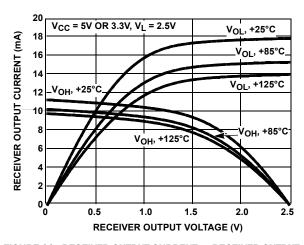
FIGURE 11. RECEIVER OUTPUT CURRENT VS RECEIVER OUTPUT VOLTAGE
