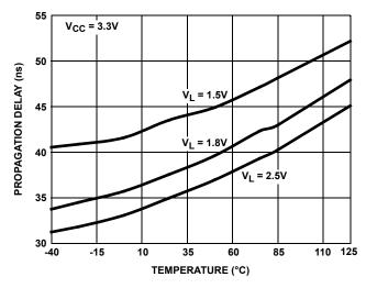
FIGURE 16. RECEIVER PROPAGATION DELAY vs TEMPERATURE
