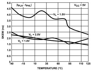
FIGURE 15. RECEIVER SKEW vs TEMPERATURE
