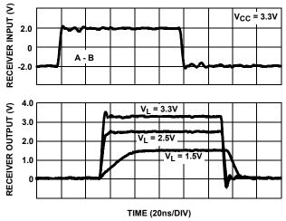
FIGURE 19. RECEIVER WAVEFORMS
