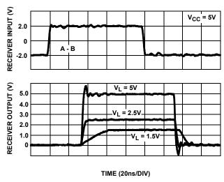
FIGURE 18. RECEIVER WAVEFORMS
