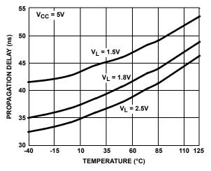
FIGURE 14. RECEIVER PROPAGATION DELAY vs TEMPERATURE
