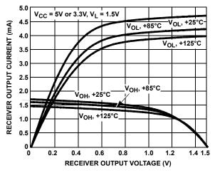
FIGURE 13. RECEIVER OUTPUT CURRENT VS RECEIVER OUTPUT VOLTAGE
