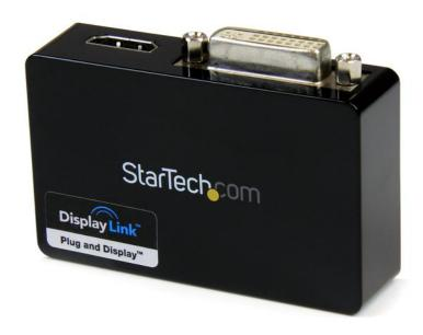
L'adaptateur USB32HDDVII USB 3.0 vers HDMI® et DVI-I à deux écrans transforme un port USB 3.0 disponible en un port DVI-I ou VGA (adaptateur DVI vers VGA inclus) et une sortie vidéo HDMI®, qui prend en charge les vidéos haute résolution 1080p et 1920 x 1200 ainsi que le son surround 5.1 (à partir d'un port HDMI® uniquement). Chaque écran peut prendre en charge simultanément la résolution maximale de 2048 x 1152 à 60 Hz.
