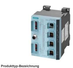
SCALANCE X201-3PIRT PRO; managed IE IRT Switch Schutzart IP65/67; 1x 10/100 Mbit/s Push Pull RJ45 Port; 3x 100 Mbit/s Push Pull SCRJ Port; Fehlermeldekontakt mit Set- Taster; redundante Spannungs- Versorgung; PROFINET IO Device; Netzwerk-Management; Redundanz-Manager integriert, inkl. elektron. Handbuch auf CD-ROM, C-PLUG optional.
