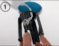
Montagefüße zusammen-drücken und in die Decken-aussparung einsetzen.
