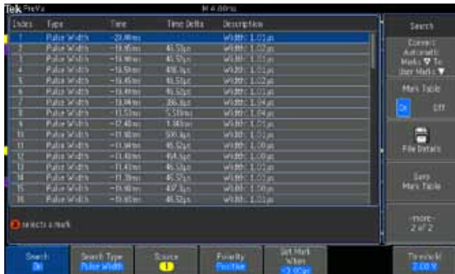
搜索步骤 3：搜索标记 (Search Mark) 表以表格视图呈现了通过自动搜索所发现的每个事件。每个事件都显示有一个时间戳，在事件之间方便地进行定时测量。
