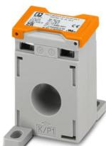
Rohrstabstromwandler, Primärstrom 250 A AC; Sekundärstrom 5 A AC; Genauigkeitsklasse 1;
