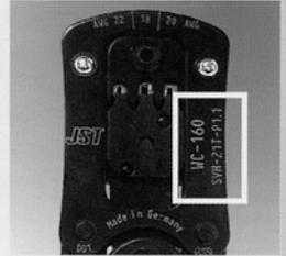
2. Zum Entriegeln des Ratschenmechanismus drücken Sie zunächst die Werkzeuggriffe zusammen. Öffnen Sie dann die Kabelschuh-Positioniereinrichtung. Bei Verwendung von Kabelschuhen von der Rolle ist zuerst ein Kabelschuh von der Rolle zu trennen und dann in die entsprechende Öffnung der Positioniereinrichtung einzusetzen. Bei der Verwendung von losen Kabelschuhen gilt die Vorgehensweise ebenfalls; ein Abtrennen von der Rolle ist dann nicht erforderlich.
