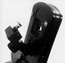
3. Schliessen Sie die Kabelschuh-Positioniereinrichtung, so dass der Kabelschuh in die richtige Lage innerhalb der Quetschbacken gebracht wird. Isolieren Sie nun ein Kabel in der empfohlenen Länge ab.
