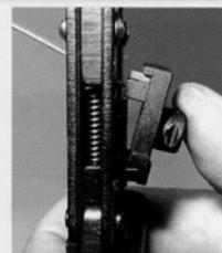
7. Falls das Werkzeug vor der Durchführung des Crimpvorganges aufgrund einer falschen Kabelschuh-Positionierung geöffnet werden muss, kann die Ratsche gelöst werden, indem Sie gegen den Freigabehebel drücken.
