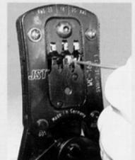
5. Der Crimpvorgang wird ausgeführt, indem Sie die Werkzeuggriffe vorsichtig zusammendrücken. Sobald die Crimpbacken vollständig ineinander fassen, wird die Ratsche automatisch gelöst und das Kabel mit dem angecrimpten Kabelschuh kann entnommen werden.
