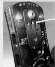
6. Bei der Entnahme des fertigen Kabels ist die Positioniereinrichtung etwas nach vorne zu ziehen, so dass sich das Kabel leichter entnehmen lässt.
