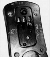
4. Überprüfen Sie die Übereinstimmung des Kabelquerschnitt mit dem zu verwendeten Crimpkontakt. Führen Sie das Kabel in die entsprechende Öffnung des Werkzeuges bis zum Kabelanschlag ein.
