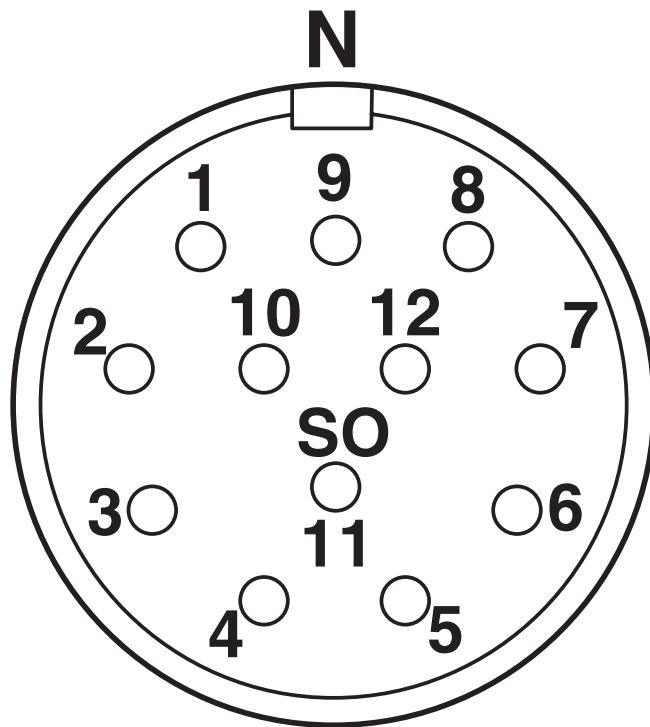
Schéma des pôles connecteur femelle M23 12 pôles, vue côté femelle
