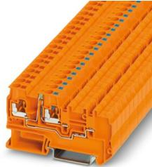
启动器/执行器接线端子，电源接线端子，标称工作电压: 24 V，额定电流: 13.5 A，连接量: 2，接线方式: 直插式连接，额定接线容量: 2.5 mm<sup>2</sup>，横截面: 0.2 mm<sup>2</sup> - 4 mm<sup>2</sup>，安装方式: NS 35/7.5, NS 35/15，颜色: 橙色
