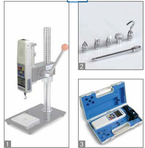
Dinamometro digitale universale per prove di trazione e compressione con sensore di misurazione integrato ed interfaccia RS-232
