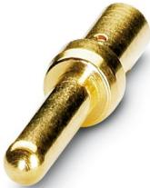
压接插针，针式插头，车削，单个插针，触点直径: 1 mm，压接范围: 0.14 mm<sup>2</sup> ... 0.56 mm<sup>2</sup>，M23-PRO系列的12和17位压接型号不需要触点释放工具，备选产品符合RoHS II非豁免 6c (Pb < 0.1 %) 产品编号：1240882
