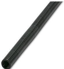
Tube de protection, matériau: PA 6, résistant aux UV: oui, souple, indice de protection: IP68, coloris: noir, classe d'inflammabilité selon UL 94: HB, diamètre intérieur: 10 mm, Longueur totale: 50 m
