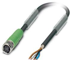
Câble pour capteurs/actionneurs, 4-pôles, PUR exempt d'halogène, gris-noir RAL 7021, blindé, extrémité libre, sur connecteur femelle droit M8, longueur de câble: 15 m
