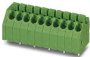
Leiterplattenklemme, Nennstrom: 8 A, Nennspannung: 400 V, Rastermaß: 3,5 mm, Polzahl: 3, Anschlussart: Push-in-Federanschluss, Montage: Wellenlöten, Anschlussrichtung Leiter/Platine: 45 °, Farbe: grün, Versetze Lötbeine, zweireihig
