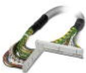
Cavo intestato; collegamento 1: IDC/FLK conduttore femmina (1x 50-poli); collegamento 2: IDC/FLK conduttore femmina (1x 50-poli); lunghezza cavo: 9,5 m
