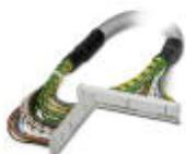
Cavo intestato; collegamento 1: IDC/FLK conduttore femmina (1x 50-poli); collegamento 2: IDC/FLK conduttore femmina (1x 50-poli); lunghezza cavo: 2,5 m
