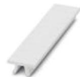
Nastro Zack, Striscia, bianco, in bianco, siglabile con: PLOTMARK, CMS-P1-PLOTTER, tipo di montaggio: inserimento a scatto in scanalatura alta portacartellini, per morsetti con spessore: 5,08 mm, dimensioni campo di siglatura: 4,98 x 10,5 mm, Numero dei cartellini singoli: 10
