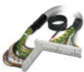
Cavo circolare confezionato schermato; collegamento 1: IDC/FLK conduttore femmina (1x 50-poli); collegamento 2: IDC/FLK conduttore femmina (1x 50-poli) (La treccia schermata è prevista su un'estremità separata del cavo.); lunghezza cavo: 0,5 m
