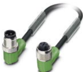
センサ/アクチュエータケーブル, 3-極, PUR ハロゲンフリー, 黒-灰RAL 7021, プラグ アングル M12, Aコーティング, 上 ソケット アングル M12, Aコーティング, ピン2と4をブリッジ, ケーブル長: 3 m
