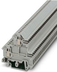
双层接线端子，\*使用的插头决定电流和电压。, 标称工作电压: 250 V, 额定电流: 10 A, 接线方式: 螺钉/插拔式连接, 第1,2层左边连接, 横截面: 0.2 mm<sup>2</sup> - 4 mm<sup>2</sup>, 安装方式: NS 35/7,5, NS 35/15, NS 32, 颜色: 灰色
