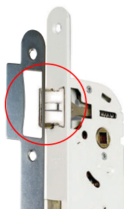
Pêne demi-tour bombé pour limiter le bruit au claquement
