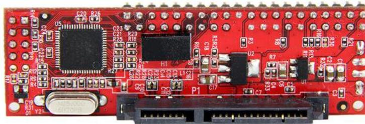
El adaptador IDE a SATA de 40 pines, modelo IDE2SAT2, permite la conexión de una unidad SATA I/II/III a un puerto IDE/ATA 33/66/100/133 de una placa base disponible, lo cual constituye una solución económica y eficaz para agregar unidades SATA más modernas a su placa base y poder seguir utilizándola.
