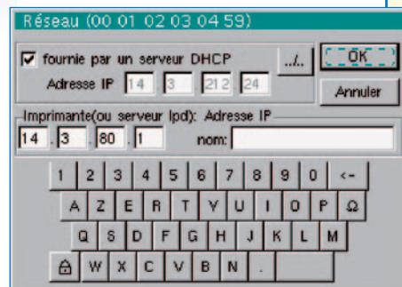
La configuration de la communication est des plus simple puisque, dans la plupart des cas, l'adresse IP de l'instrument est fournie automatiquement par le serveur local ; il suffit d'entrer l'adresse de l'imprimante à utiliser.
