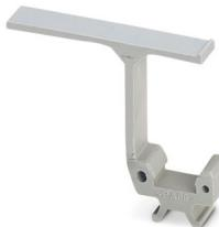
组标识，可卡在端子中心，适用螺钉、弹簧、直插和快速接线端子，可使用24 x 4 mm或B-STIFT标识，底部采用ZB 5
