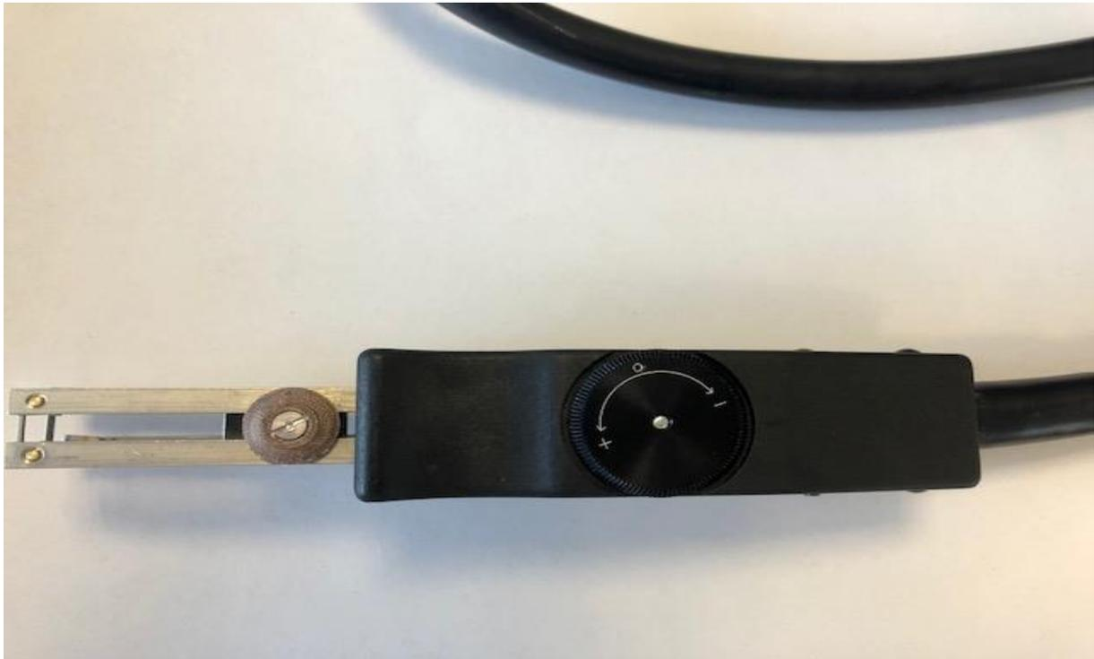
Afin d'adapter la pince aux différents diamètres de câble, cette dernière est munie d'un réglage de hauteur, ce qui permet de déclencher la chauffe des électrodes plus ou moins tôt. C'est-à-dire plus la section du câble est importante et plus tôt il faut déclencher la chauffe.
