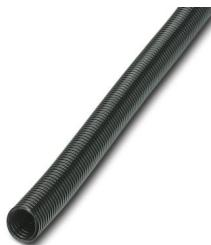
Schutzschlauch, Material: PA 6, UV-beständig: ja, flexibel, Schutzart: IP68, Farbe: schwarz, Brennbarkeitsklasse nach UL 94: V0, Innendurchmesser: 10 mm, Gesamtlänge: 50 m
