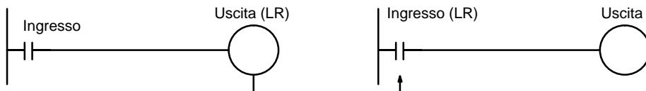
Le seguenti condizioni sono prese come esempio per calcolare i tempi di risposta degli I/O. Nel CPM1/CPM1A, i canali dell'area LR da LR 00 a LR 15 sono usati nei collegamenti one-to-one e il tempo di trasmissione è fissato a 39 ms.
