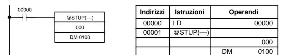
Le impostazioni vengono trasferite come riportato di seguito. Al termine del trasferimento, il flag di modifica setup RS-232C (SR 25312) passa su OFF.
