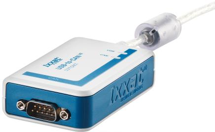
Le dispositif Ixxat USB-to-CAN V2 compact avec une isolation galvanique est un moyen simple et rentable de connecter un ordinateur à un réseau de bus CAN. C'est une bête de somme très fiable pour les applications CAN, par exemple dans le domaine des applications de test, de développement, de maintenance ou de contrôle.
