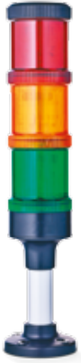
Référence: ECO70-Q01 Couleurs: rouge-orange-vert Fonction: Feu LED fixe Tension nominale: 24 V AC/DC Type de montage: Montage de tube (longueur de tube 100 mm)
