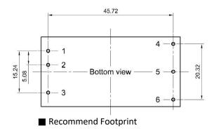
Unit : mm PIN Tol : ±0.1 Tolerance : ±0.35
