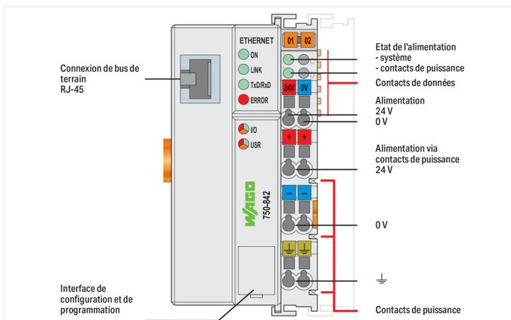
Le contrôleur ETHERNET combine la fonctionnalité de commande, de couplage E/S et d'ETHERNET dans un seul appareil. La constitution du programme est effectuée dans cinq langages disponibles dans l'outil de programmation selon la norme CEI 61131-3. Grâce à l'utilisation des blocs fonctionnels, il est possible de configurer des clients et serveurs pour tous les protocoles de transport (TCP, UDP, etc.) par l'intermédiaire des Socket-API.
