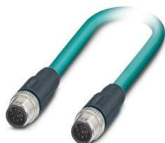
Netzwerkkabel, Ethernet CAT5 (1 GBit/s), 8-polig, PUR halogenfrei, wasserblau RAL 5021, Stecker gerade M12, Kodierung: A / IP67, auf Stecker gerade M12, Kodierung: A / IP67, Kabellänge: 2 m
