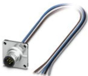
センサ/アクチュエータ筐体取付プラグ、5極、M12、Aコーディング、前面/角形フランジ取付け、0.5 mのTPEばら線、5 x 0.34 mm 2
