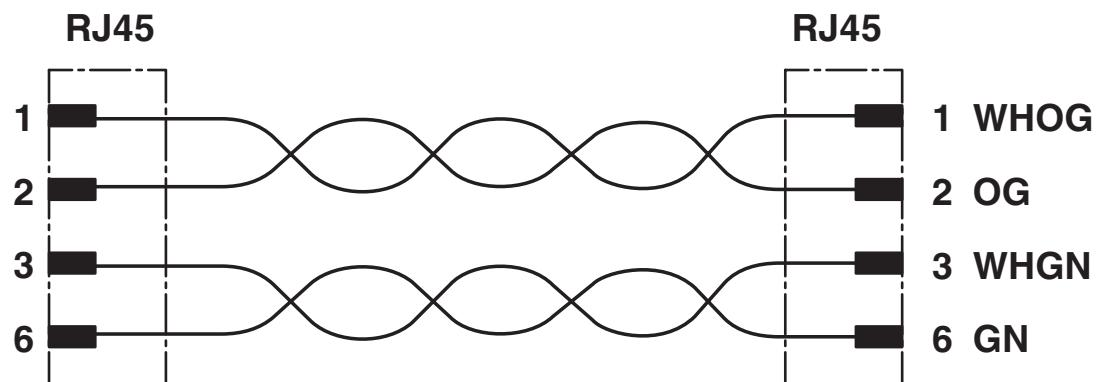
Kontaktbelegung der RJ45-Stecker
