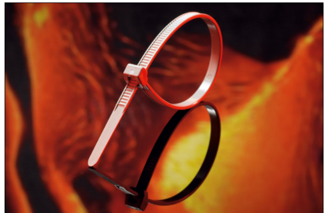
Låsehovedets design gør, at det optager lidt plads, har lav indførselskraft og høj trækstyrke.
