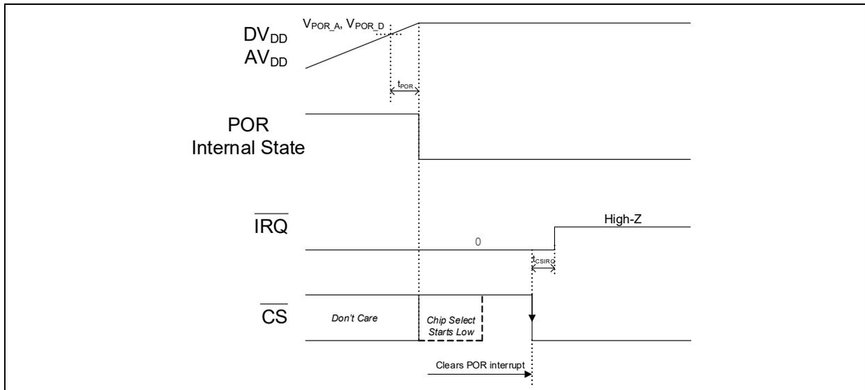
**FIGURE 6-15:**  $\overline{\text{IRQ}}$  Timing Diagram.
