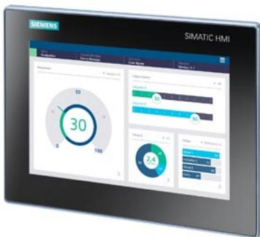
SIMATIC HMI MTP1000, Unified Basic Panel, Touchbedienung, 10" Widescreen-TFT-Display, 16 MIO Farben, PROFINET Schnittstelle, projektierbar ab WinCC Unified Basic V18 Upd. 3, enthält Open Source SW, die unentgeltlich überlassen wird siehe beiliegende Blu-Ray
