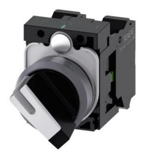
interruptor com manípulo, iluminável, 22 mm, redondo, plástico com anel frontal metálico, branco, manípulo, curto, 2 posições de comutação O-I, de encaixe, Ângulo de comutação 90°, 10:30h/13:30h, com suporte, 1NA, 1NF, conexão de mola
