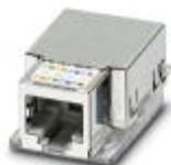
RJ45-Buchseinsatz, Schutzart: IP20, Polzahl: 8, CAT5 (IEC 11801:2002), Material: Kupferlegierung, Anschlussart: IDC, Anschlussquerschnitt: AWG 24- 22
