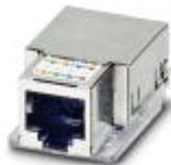
RJ45-Buchseinsatz, Schutzart: IP20, Polzahl: 8, Anschlussart: IDC, Anschlussquerschnitt: AWG 26- 22
