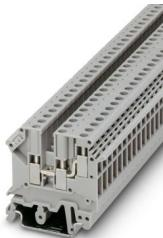
直通式接线端子，标称工作电压: 500 V，额定电流: 32 A，连接量: 3，接线方式: 螺钉连接，第一层，额定接线容量: 4 mm<sup>2</sup>，横截面: 0.2 mm<sup>2</sup> - 4 mm<sup>2</sup>，安装方式: NS 35/7,5，NS 35/15，NS 32，颜色: 灰色
