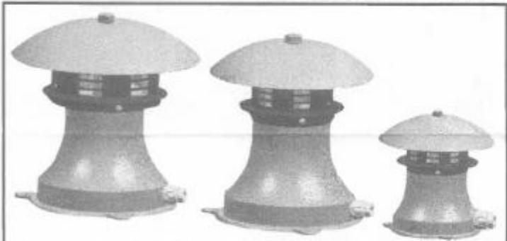
Sirene elettromeccaniche industriali per servizio continuo (BA = On  $\infty$ ) a basso assorbimento DC (12V - 24V); e per servizio non continuo (VAC/DC). Nelle CELEREST e SUPERCELEREST versioni 110VAC - 230VAC vi è installato un termointerruttore di protezione motore. Tipo di alimentazione per utilizzo continuo: On: 1 min. Off: 10 min.
