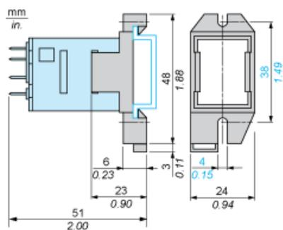
Con questo tipo di montaggio, il pulsante test diventa inaccessibile.
