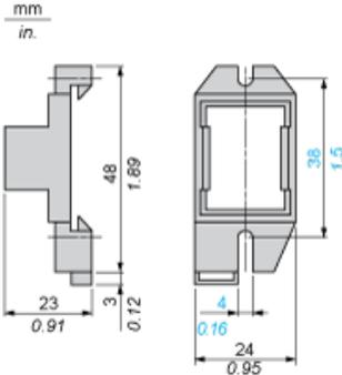
Montaggio dell'adattatore per guide
