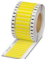
Schrumpfschlauch, Rolle, gelb, unbeschriftet, beschriftbar mit: THERMOMARK E.300 (D)/600 (D), THERMOMARK ROLLMASTER 300/600, THERMOMARK ROLL X1, THERMOMARK ROLL, THERMOMARK ROLL 2.0, THERMOMARK X1.2, Kabeldurchmesserbereich: 2,4 ... 4,8 mm, unperforiert, Montageart: aufschieben, Anzahl der Einzelschilder: 1000, Textfeldhöhe: 9 mm, Textfeldbreite: 60 mm
