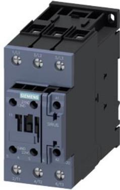
Leistungsschütz, AC-3e/AC-3, 80 A, 37 kW / 400 V, 3-polig, DC 24 V, 0,8-1,2\* US, mit integriertem Varistor, Hilfskontakte: 1 S + 1 Ö, Schraubanschluss, Baugröße: S2, geeignet für SPS-Ausgänge
