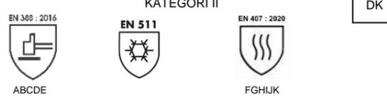
A : Slitage (0-4) B : Skærefasthed (0-5) C : Rivstyrke (0-4) D : Punktering (0-4) E : TDM skærefasthed ISO 13997 (A-F) F : Begrænset flammespredning (0-4) G : Varme – (0-4) H : Varme – isolering (0-4) I : Strålevarme (0-4) J : Smeltet metal (mindre stænk) (0-4) K : Smeltet metal (store stænk) (0-4)
