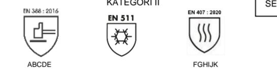
A : Nötningsmotstånd (0-4) B : Skärbeständighet (0-5) C : Rivhållfasthet (0-4) D : Punkteringsmotstånd (0-4) E : TDM skärbeständighet ISO 13997 (A-F) F : Begränsad flamspridning (0-4) G : Skydd mot kontaktvärme (0-4) H : Skydd mot öppen låga (0-4) I : Skydd mot strålningvärme (0-4) J : Skydd mot smält metall (droppar) (0-4) K : Skydd mot smält metall (flytande) (0-4)
