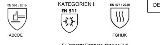
A : Abriebfestigkeit (0-4) B : Schnittfestigkeit (0-5) C : Weiterreißfestigkeit (0-4) D : Durchstichfestigkeit (0-4) E : Schnittfestigkeit nach ISO 13997 (A-F) F : Begrenzte Flammenausbreitung (0-4) G : Kontaktwärme (0-4) H : Konvektive Hitze (0-4) I : Strahlungswärme (0-4) J : Wärmebelastung durch kleine Spritzer geschmolzenen Metalls (0-4) K : Wärmebelastung durch große Mengen geschmolzenen Metalls (0-4)
