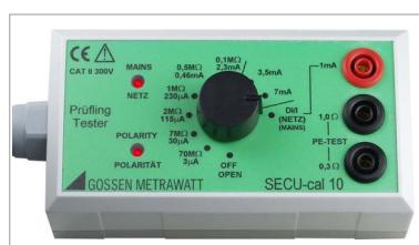
Es sind dabei alle Grenzwerte für die geforderten Prüfungen nach DIN VDE wie Schutzleiterwiderstand, Isolationswiderstand, Ersatzableitstrom, Differenz- und/oder Berühr- bzw. Gehäuseableitstrom zu überprüfen.
