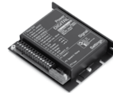
DEC 50/5 1-Q-EC Verstärker 1-Quadrant-Verstärker zur Ansteuerung von EC-Motoren mit Hall-Sensoren bis zu einer maximalen Leistung von 250 Watt.
