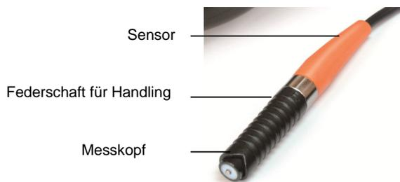
Der Sensor ist am unteren Schaftsegment anzufassen und wird nur leicht auf das Prüfobjekt angedrückt.
