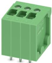
印制电路板终端，额定电流: 17.5 A，额定电压(III/2): 320 V，额定横截面: 1.5 mm<sup>2</sup>，电位数: 3，行数: 1，每行位数: 3，产品系列: FRONT 1,5-V，针距: 3.81 mm，接线方式: 正面螺钉连接，安装: 波峰焊，导线/PCB连接方向: 90°，颜色: 绿色，针脚排列: 直线排列，焊针[P]: 3.5 mm，每个电势的焊针数量: 2，包装类型: 纸箱包装
