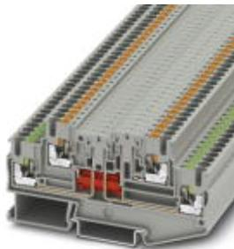
Blocs de jonction simple, Mode de raccordement: Raccordement Push-in, Section : 0,14 mm<sup>2</sup> - 4 mm<sup>2</sup>, AWG: 26 - 12, Largeur: 5,2 mm, Coloris: gris, Type de montage: NS 35/7,5, NS 35/15
