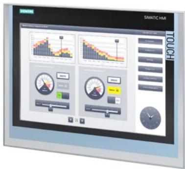
SIMATIC HMI TP1500 Comfort, Comfort Panel, Touchbedienung, 15" Widescreen-TFT-Display, 16 MIO Farben, PROFINET Schnittstelle, MPI/PROFIBUS-DP Schnittstelle, 24MByte Projektierungsspeicher, WEC 2013, projektierbar ab WinCC Comfort V14 SP1 mit HSP, Umgebungstemperatur bis zu 45°C
