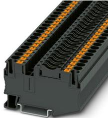
保险丝接线端子，保险丝类型：扁形，保险丝类型：C型/最高2.2 W，标称工作电压：400 V，额定电流：25 A，接线方式：直插式连接，额定接线容量：6 mm<sup>2</sup>，接线容量：0.5 mm<sup>2</sup>-10 mm<sup>2</sup>，安装方式：NS 35/7.5，NS 35/15，颜色：黑色
