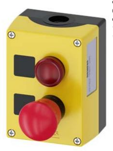
Boîtier pour appareils de commande, 22 mm, rond, matériau du boîtier : plastique, partie supérieure du boîtier : jaune, 2 emplacements de commande en plastique, B = voyant lumineux rouge, LED 24 V, borne à vis, plaquette sans inscription, A = arrêt d'urgence 40 mm décrochage par rotation, plaquette sans inscription, 1 NO, 1 NF, 1 NF, borne à vis, fixation au sol, en haut et en bas 1xM20 chacun, étiquettes jointes
